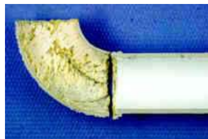
Rys. 1. Kształtka z kopolimeru PP zgrzana z rurą Beta-PP-H po kontakcie z substancją utleniającą (30% nadtlenek wodoru)
