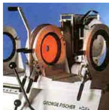
Rys. 5. W przypadku zgrzewania PVDF temperatura elementu grzejnego osiąga 508°C, a nagrzewanie elementu do 240°C przebiega znacznie łagodniej.
