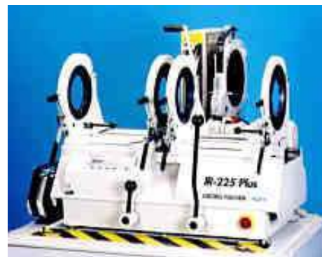
Rys. 8. Maszyna warsztatowa serii IR Plus do wykonywania protokołowanych zgrzewów do średnicy d225 mm.
